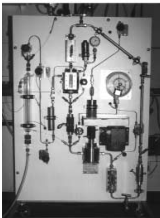
Abbildung 8. Schematische Darstellung und Ansicht eines Schlaufenreaktors zur Ermittlung der Lebensdauer ionischer Übergangsmetallkatalysator-Lösungen.
